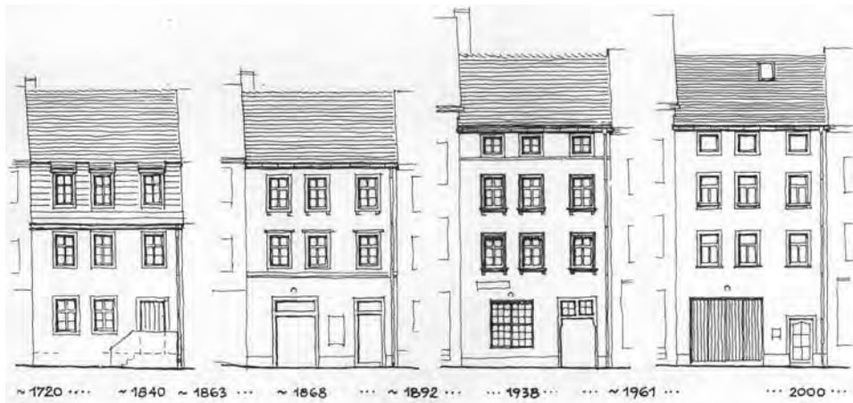
Bauetappen auf dem Grundstück IV.83 Pauritzer Gasse 34 (Fassade)
